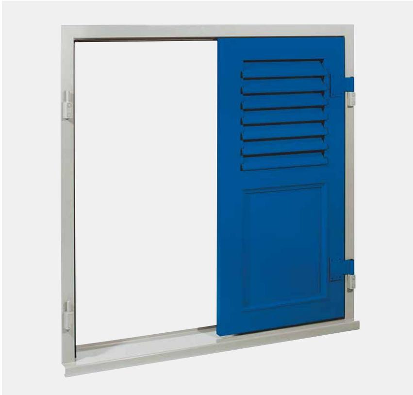
**Zargenelement:** Fertigelement mit stranggepresster Aluminiumzarge, pulverbeschichtet, mit Anschlagdichtung. Das Element wird montagefertig geliefert, einschliesslich vormontierter Beschläge.
