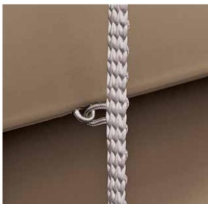
**Optimale Verbindung:** Die patentierte, wartungsfreie Verbindung zwischen Lamelle und Tragschnur erfolgt mit einer rostfreien Stahlöse, die ohne Schwächung der Lamelle in die Bördelung eingeschossen wird.
