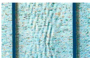
Beispiel Welligkeit im Bahnenbereich Exemple ondulation dans les zones des bords de lés Esempio ondulazioni sulla banda
